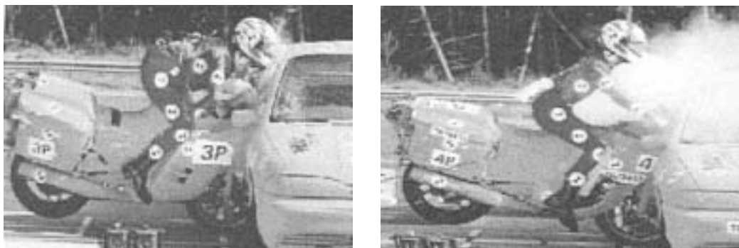
Figur 5: Sidokollision i 48 km/t utan airbag (till höger) och med airbag (till vänster). Illustration hämtat från Chinn mf.l. (1996).
