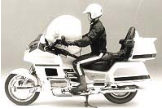
Figur 4: Honda Goldwing 1500 med utlöst airbag.
