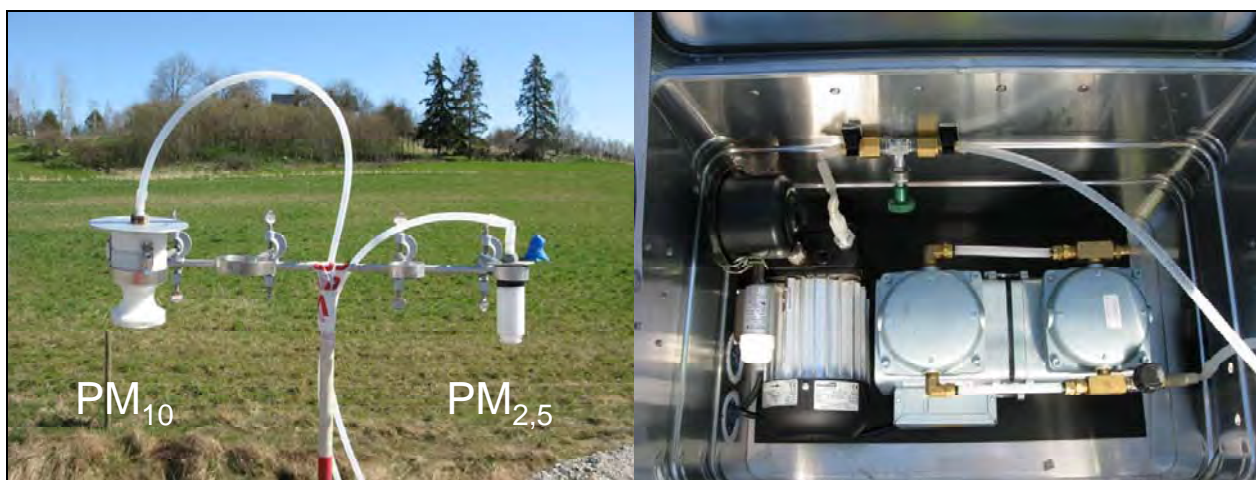
Figur 7 Aktiva partikelprovtagare (PM 10 och PM 2,5 ) och box med pumpar som driver vardera provtagare.
