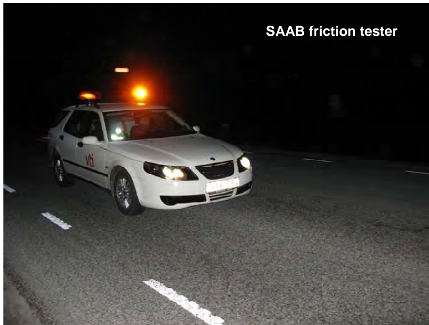
Figur 9 SAAB Friction Tester under ett mätförlopp på Riksväg 34.
