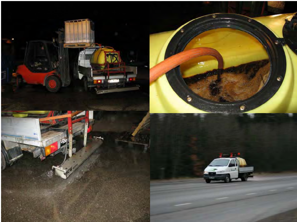
Figur 4 Spridarbil från BEFAB utrustad med en ramp med spraydysor och Epoke styrsystem för dosering av giva. Påfyllning av tanken (övre bilderna). Spridarramp (nedre vänstra bilden). Spridning på väg (nedre högra bilden).
