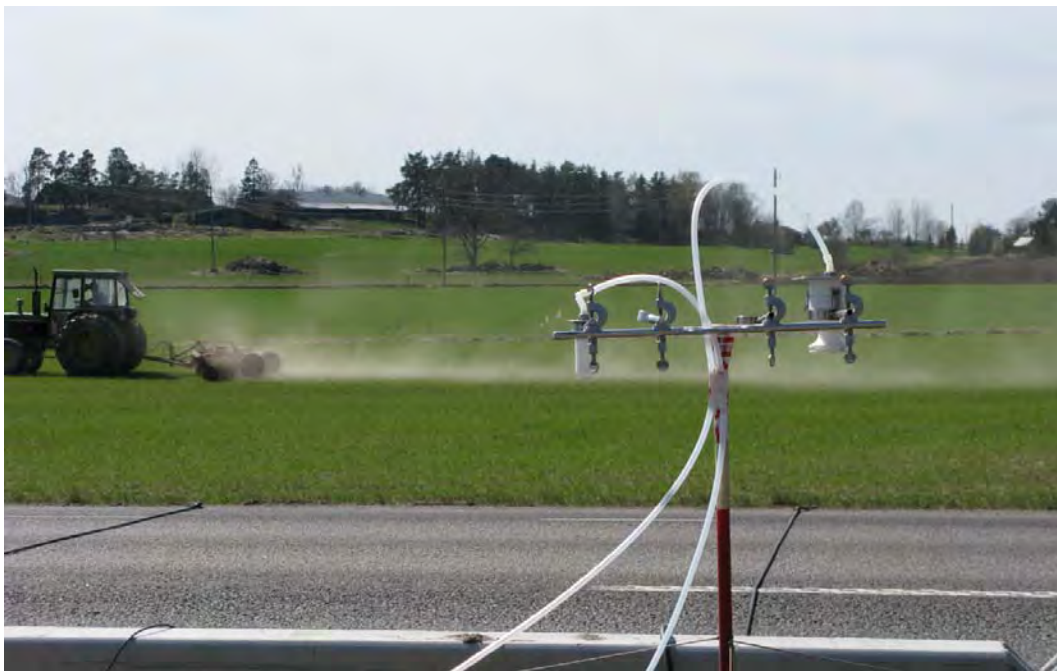
Figur 19 Lokala dammemissioner stör mätningarna.
