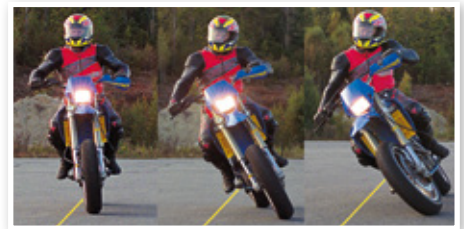
Motstyrning. Ett exakt tryck på höger styrhandtag och cykeln välter över åt höger.
