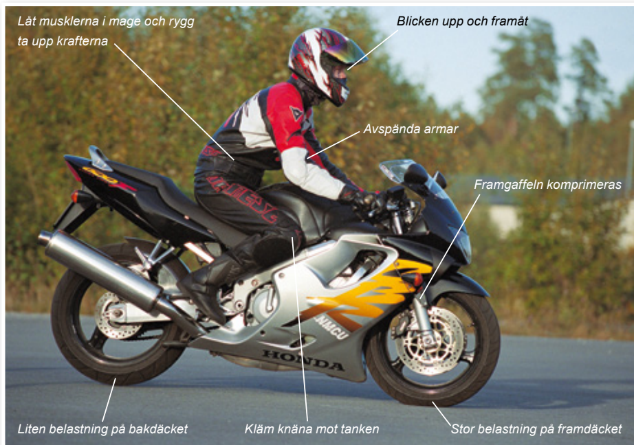
Sittställning vid inbromsning. Kläm knäna mot tanken, låt musklerna i ben, mage och rygg ta upp krafterna och avlasta armarna så mycket som möjligt.
